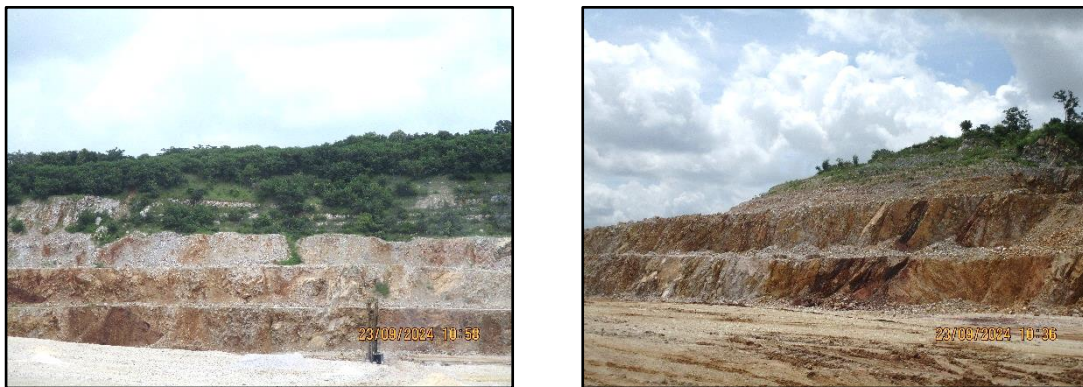
ภาพที่ 2.7 การเปิดหน้าเหมืองแบบขั้นบันได
