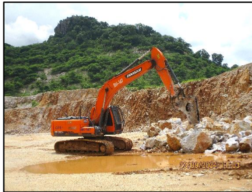
ภาพที่ 2.29 Hydraulic Breaker สำหรับทุบหิน
